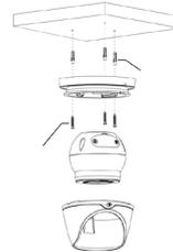
**Schritt 5:** Um die Kamera zu positionieren richten Sie sie am Dreieckssymbol aus und drehen sie in die auf der Abbildung dargestellte Richtung.
