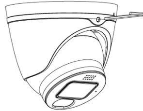
**Schritt 3:** Drehen Sie den Sockel und richten Sie die Schraube am Dreieckssymbol aus, entfernen Sie dann die Kamera wie in der Abbildung unten gezeigt.
