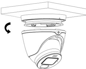
**Schritt 6:** Richten Sie die Kamera im gewünschten Winkel aus und ziehen Sie die Schraube wieder fest, um die Kamera zu sichern.
