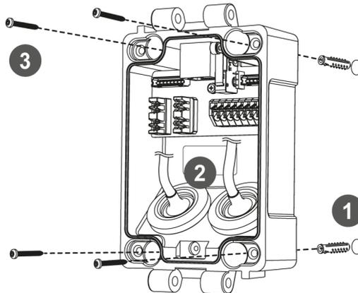
4. Schließen Sie die Strom- und E/A-Drähte und das Netzkabel an den Terminals an. Das Netzkabel kann entweder über den RJ45-Anschluss oder die LSA-Anschlüsse verbunden werden.
