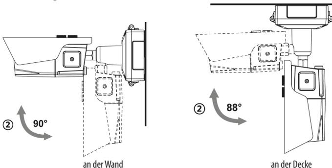
3. Drehwinkel (horizontale Bildausrichtung): Der Drehwinkel ist begrenzt auf max.  $\pm 90^\circ$ .
