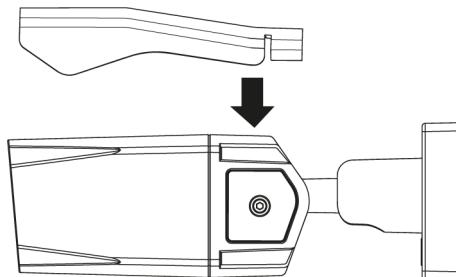
2. Faites-le glisser vers l'avant sur le boîtier avant de la caméra.
