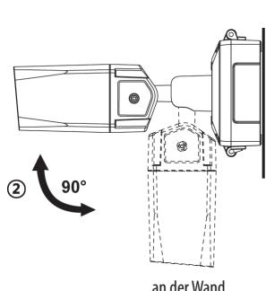
3. Drehwinkel (horizontale Bildausrichtung): Der Drehwinkel ist begrenzt auf max. +/-90°.
