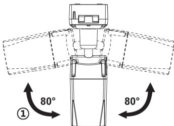
2. Neigungswinkel: Die Neigung ist bei Wand- (bzw. Decken)-Installation auf min. 0°(2°) bis max. 90° begrenzt, wobei vorausgesetzt wird, dass die Neigung des Kameramoduls in Bezug auf die Wand (bzw. Decke) 0° ist, d.h., dass das Bild horizontal ausgerichtet ist.
