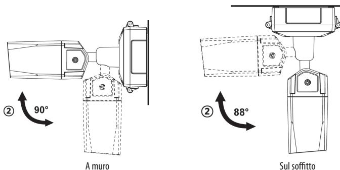
3. Limite inclinazione (allineamento immagine orizzontale): l'inclinazione è limitata a  $\pm 90^\circ$  max.
