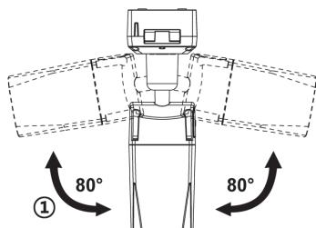
2. Limite inclinazione: l'inclinazione è limitata a  $0^\circ(2^\circ)$  min ~  $90^\circ$  max. per l'installazione a muro (soffitto) rispetto al muro (soffitto) quando l'inclinazione del modulo telecamera è  $0^\circ$ , ossia l'immagine è disposta orizzontalmente.
