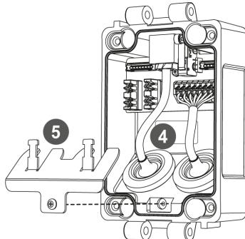
6. Monter la partie supérieure de la boîte de jonction sur l'embase de cette dernière en utilisant un axe de charnière. L'axe peut être inséré de chaque côté, selon la préférence.
