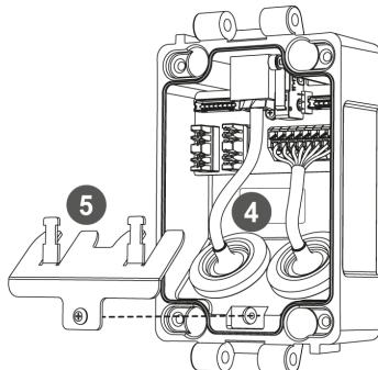
6. Befestigen Sie den Deckel der Anschlussbox mit dem Scharnierstift an der Basis der Anschlussbox. Der Stift kann von beiden Seiten eingeführt werden.
