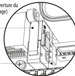
Interrupteur d'alarme d'ouverture du couvercle (alarme de sabotage)
