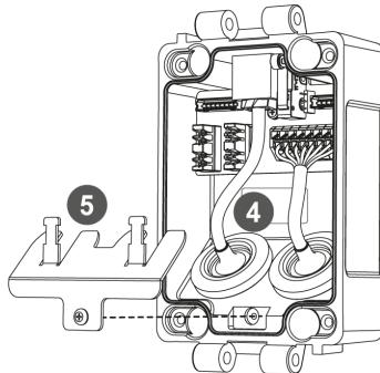
6. Montare il coperchio della scatola di giunzione sulla base utilizzando un perno cerniera. Il perno può essere inserito su entrambi i lati, a seconda della comodità.
