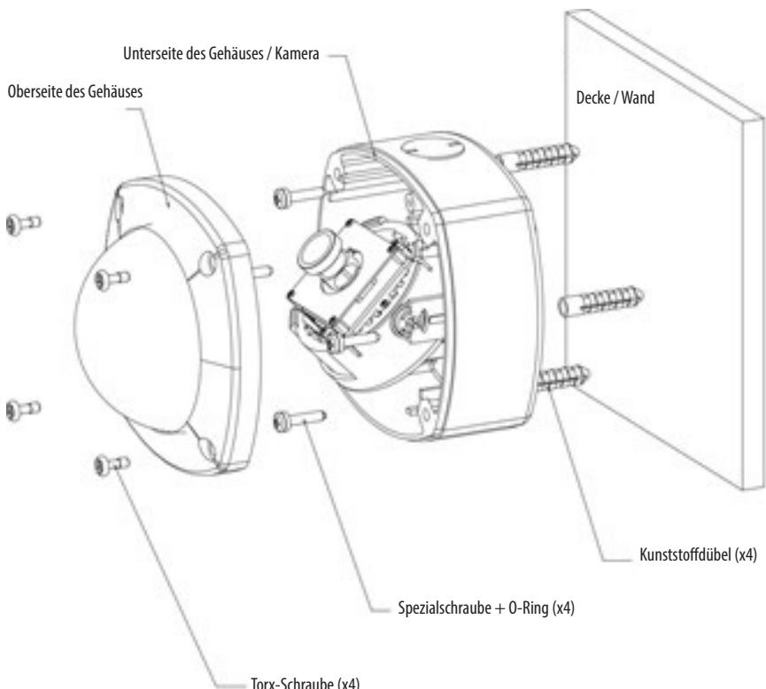
**ACHTUNG:** Drehen Sie die Kamera nicht in die gleiche Richtung weiter. Dadurch könnte der Kabelstecker abgetrennt werden.
