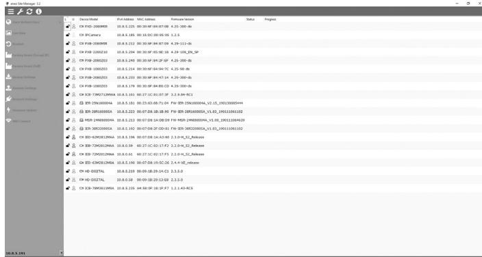
Selezionare la telecamera dall'elenco e, facendo clic con il tasto destro del mouse, aprire il menu di scelta rapida. Selezionare l'opzione "Network Settings" per aprire una finestra in cui impostare le proprietà IP della telecamera.
