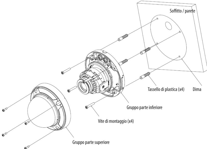
4. Applicare la parte anteriore dell'alloggiamento sulla parte inferiore e serrare le 4 viti Torx.
