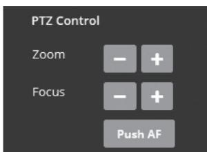
Utilizzato per regolare lo zoom/la messa a fuoco manualmente o la messa a fuoco one-push automaticamente.
