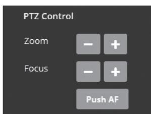
Zur manuellen Zoom-/Fokus-Einstellung oder zur automatischen Fokussierung mittels One-Push-Automatik.
