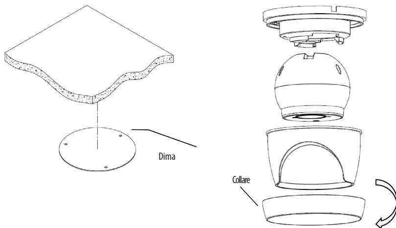
3. Fissare la base della telecamera con le tre viti fornite nel kit di accessori.
