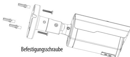
2. Stellen Sie den Kamerawinkel ein und ziehen Sie die Halterung mit dem Inbus-schlüssel fest.
