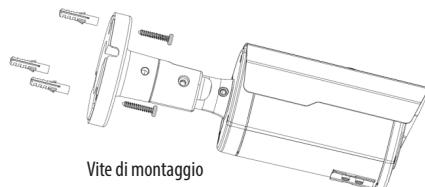
2. Regolare l'angolazione della telecamera e serrare il supporto utilizzando la chiave a L.
