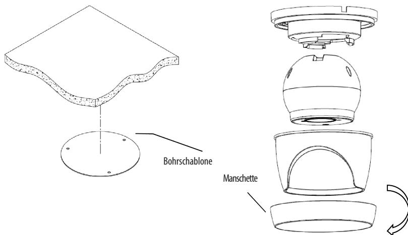
3. Befestigen Sie die Unterseite der Kamera mit den im Montageset mitgelieferten drei Schrauben.
