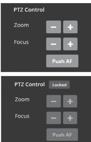
Utilisé pour ajuster manuellement le zoom/focus ou effectuer une mise au point automatiquement par simple pression.
