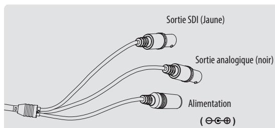
**i** Utilisez le câble fourni avec la caméra. Si le câble de la caméra est coupé et re-câblé, la distance de transmission de la vidéo peut être réduite. En particulier, le câble SDI ne doit pas être coupé car il nécessite un travail de câblage détaillé et affecte la distance de transmission.
