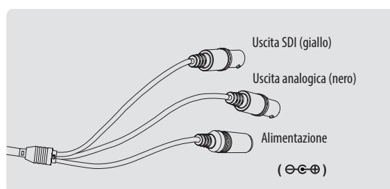
**i** Utilizzare il cavo fornito con la telecamera. Se il cavo della fotocamera viene tagliato e ricollegato, la distanza di trasmissione del video può essere ridotta. Soprattutto il cavo SDI non deve essere tagliato perché richiede un lavoro di cablaggio dettagliato e incide sulla distanza di trasmissione.
