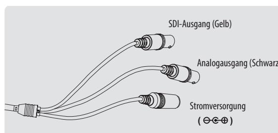
**i** Bitte benutzen Sie das mitgelieferte Kabel. Wenn das Kamerakabel durchgeschnitten und neu verdrahtet wird, kann die Übertragungsstrecke des Videos verkürzt werden. Insbesondere sollte das SDI-Kabel nicht geschnitten werden, da es eine genaue Verdrahtung erfordert und die Übertragungsstrecke beeinflusst.
