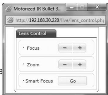
Mise au point : cliquer sur le bouton « - » pour une mise au point éloignée et sur le bouton « + » pour une mise au point proche.
