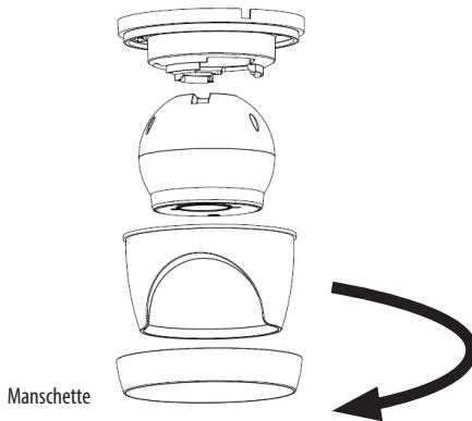
2. Entfernen Sie die Manschette von der Kamera durch die Drehung.
