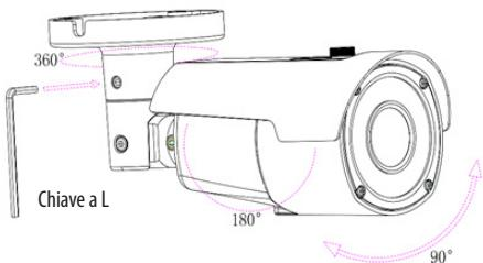
2. Regolare l'angolazione della telecamera e serrare il supporto utilizzando la chiave a L.
