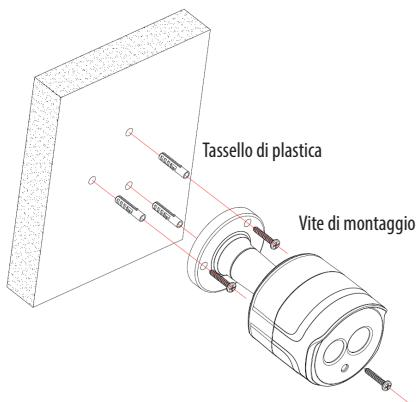
Per montare la telecamera bullet, fissare la base della telecamera con le tre viti fornite nel kit di accessori.
