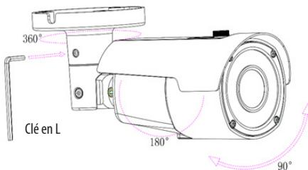
2. Adaptez l'angle de la caméra et serrez le montage en utilisant une clé en L.
