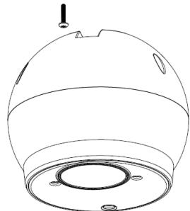
3. Befestigen Sie die Unterseite der Kamera mit den im Montageset mitgelieferten drei Schrauben.
