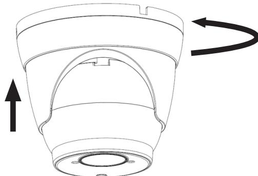
4. Bringen Sie die Manschette durch die Drehung in die Ausgangsposition.
