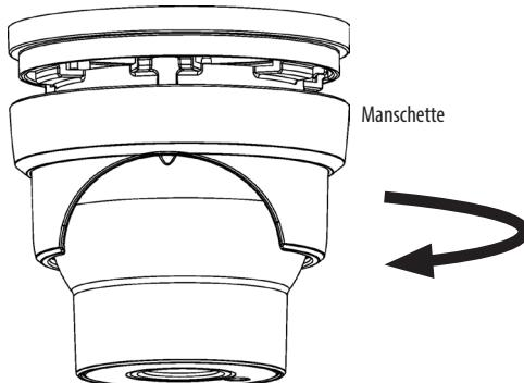
2. Entfernen Sie die Manschette von der Kamera durch die Drehung.
