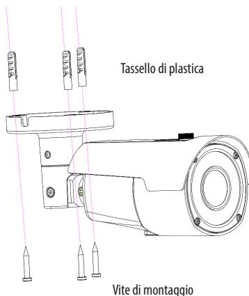
1. Per montare la telecamera, fissare la base della telecamera con le tre viti fornite nel kit di accessori.
