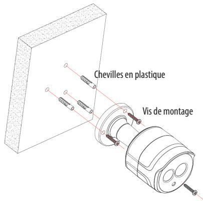
Pour monter la caméra bullet, fixez la base de la caméra à l'aide des 3 vis fournies dans le kit d'accessoires.
