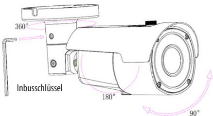
2. Stellen Sie den Kamerawinkel ein und ziehen Sie die Halterung mit dem Inbus-schlüssel fest.
