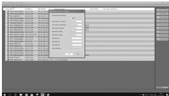
Sélectionnez l'option « Set IP Address [dhcp / static] » pour ouvrir une fenêtre permettant de paramétrer les propriétés IP de la caméra. Ensuite, cliquez sur « OK » pour mettre à jour les réglages de la caméra.
