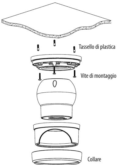
3. Fissare la base della telecamera con le tre viti fornite nel kit di accessori.
