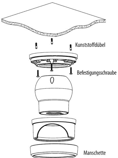
3. Befestigen Sie die Unterseite der Kamera mit den im Montageset mitgelieferten drei Schrauben.
