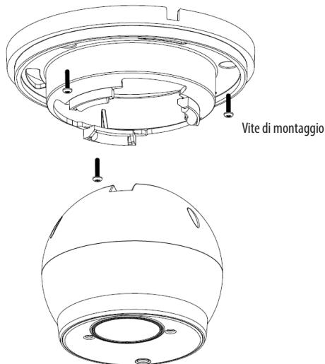
3. Fissare la base della telecamera con le tre viti fornite nel kit di accessori.
