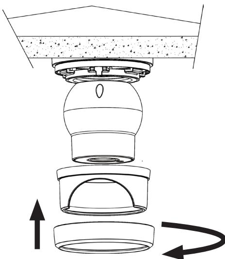
4. Bringen Sie die Manschette durch die Drehung in die Ausgangsposition.
