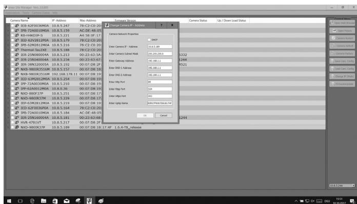
Selezionare l'opzione "Set IP Address [dhcp / static]" (Imposta indirizzo IP [dhcp / statico]) per aprire una finestra in cui impostare le proprietà IP della telecamera. Al termine fare clic sul pulsante "OK" per aggiornare le impostazioni della telecamera.
