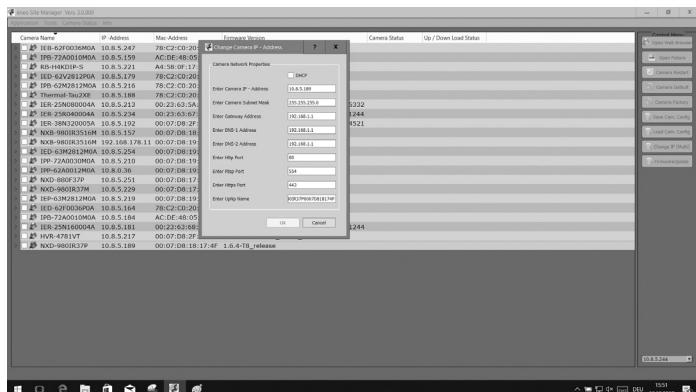
Wählen Sie die Option "Set IP Address [dhcp / static]" um ein Fenster für die Kamera IP-Einstellungen zu erhalten. Wenn Sie fertig sind, klicken Sie den "OK" Button um die Kameraeinstellungen zu aktualisieren.
