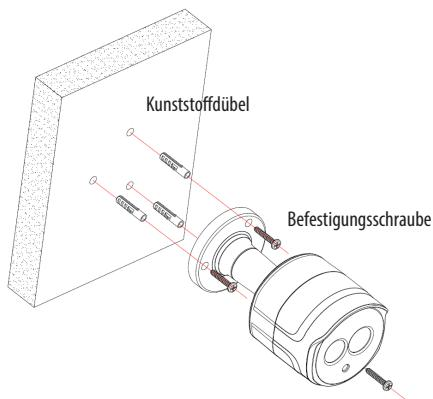
Für die Montage der Bullet-Kamera befestigen Sie die Unterseite der Kamera mit den im Montageset mitgelieferten drei Schrauben.
