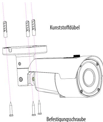
1. Für die Montage der Kamera befestigen Sie die Unterseite der Kamera mit den im Montageset mitgelieferten drei Schrauben.
