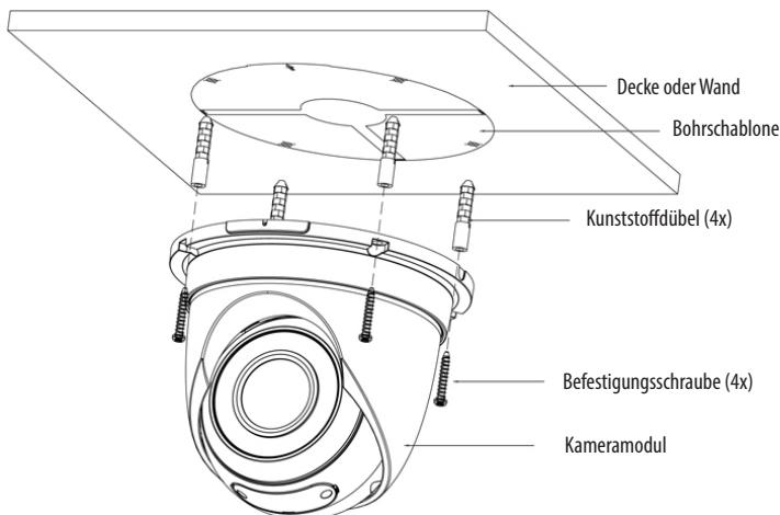
1. Bohren Sie die Löcher mit Hilfe der beiliegenden Schablone in die Decke.
