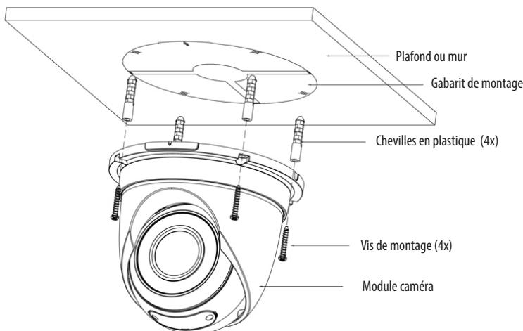
1. Percer les trous au plafond au moyen des gabarits de montage fournis.
