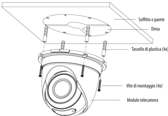
1. Fare i buchi per le viti sul soffitto utilizzando la dima fornita.
