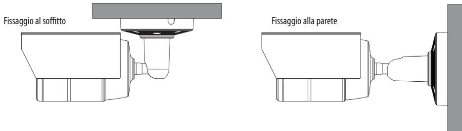
**ATTENZIONE:** se si regola la posizione della telecamera dopo l'installazione si rischia di danneggiare il cavo.
