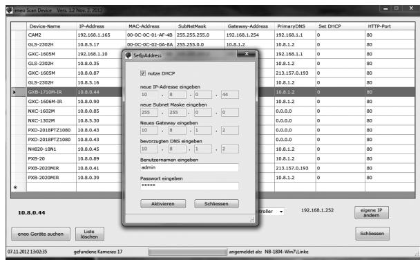
Wählen Sie die „Kamera IP Adresse bearbeiten“ Option um ein Fenster für die Kamera IP-Einstellungen zu erhalten. Wenn Sie fertig sind, klicken Sie den „Aktivieren“ Button um die Kameraeinstellungen zu aktualisieren.
