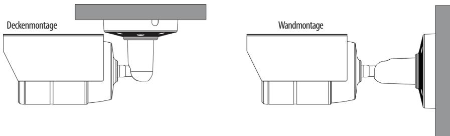
**ACHTUNG:** Wenn Sie die Position der Kamera nach der Installation verändern, könnte das Kabel möglicherweise beschädigt werden.
