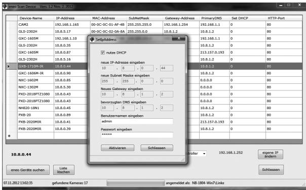
Selezionare l'opzione "Editing the camera IP address" (Cambia l'indirizzo IP della telecamera) per aprire una finestra in cui impostare le proprietà IP della telecamera. Al termine fare clic sul pulsante "Activate" (Attiva) per aggiornare le impostazioni della telecamera.
