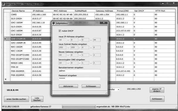
Selectionner l'option « Editing the camera IP address » (taper l'adresse de la caméra IP) pour ouvrir une fenêtre et rentrer l'adresse IP. Quand vous avez fini, cliquer sur "activate" (activer) pour actualiser les paramètres de la caméra.
