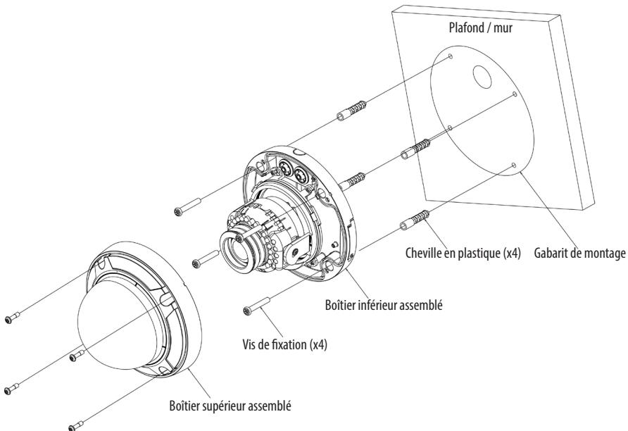
4. Poser l'avant du boîtier sur la base et serrer les 4 vis torx.
