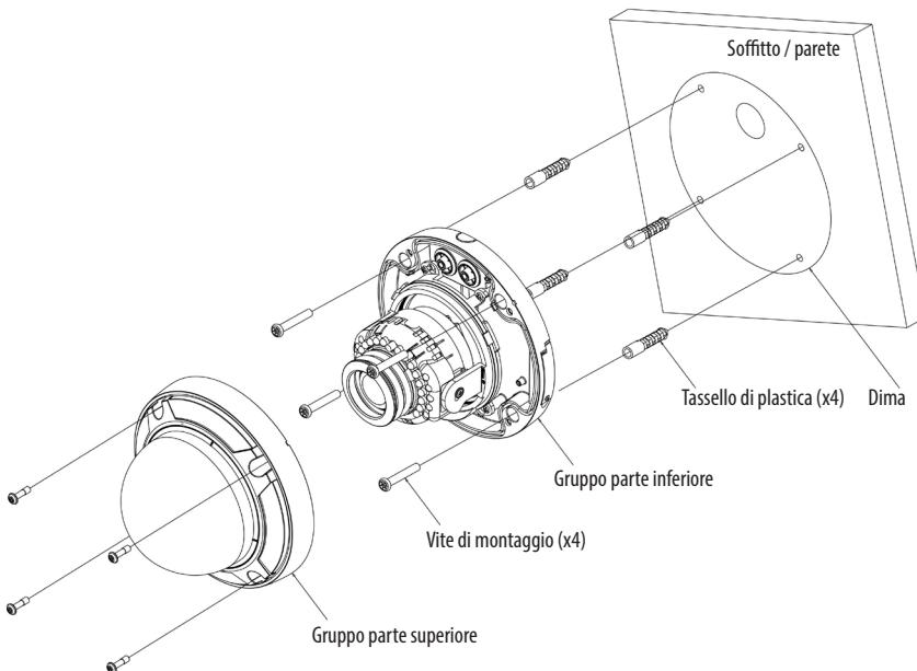
4. Applicare la parte anteriore dell'alloggiamento sulla parte inferiore e serrare le 4 viti Torx.
