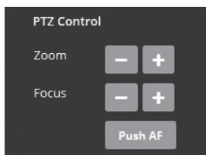
Se utiliza para ajustar el zoom/enfoque manualmente o el enfoque automático de una pulsación.
