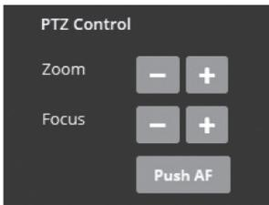
Utilizzato per regolare lo zoom/la messa a fuoco manualmente o la messa a fuoco one-push automaticamente.
