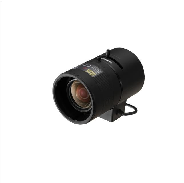
F1,4/3,8-17mm, 8.0 MP, DC-Objektiv mit variabler Brennweite, 1/1,7", CS-Mount
